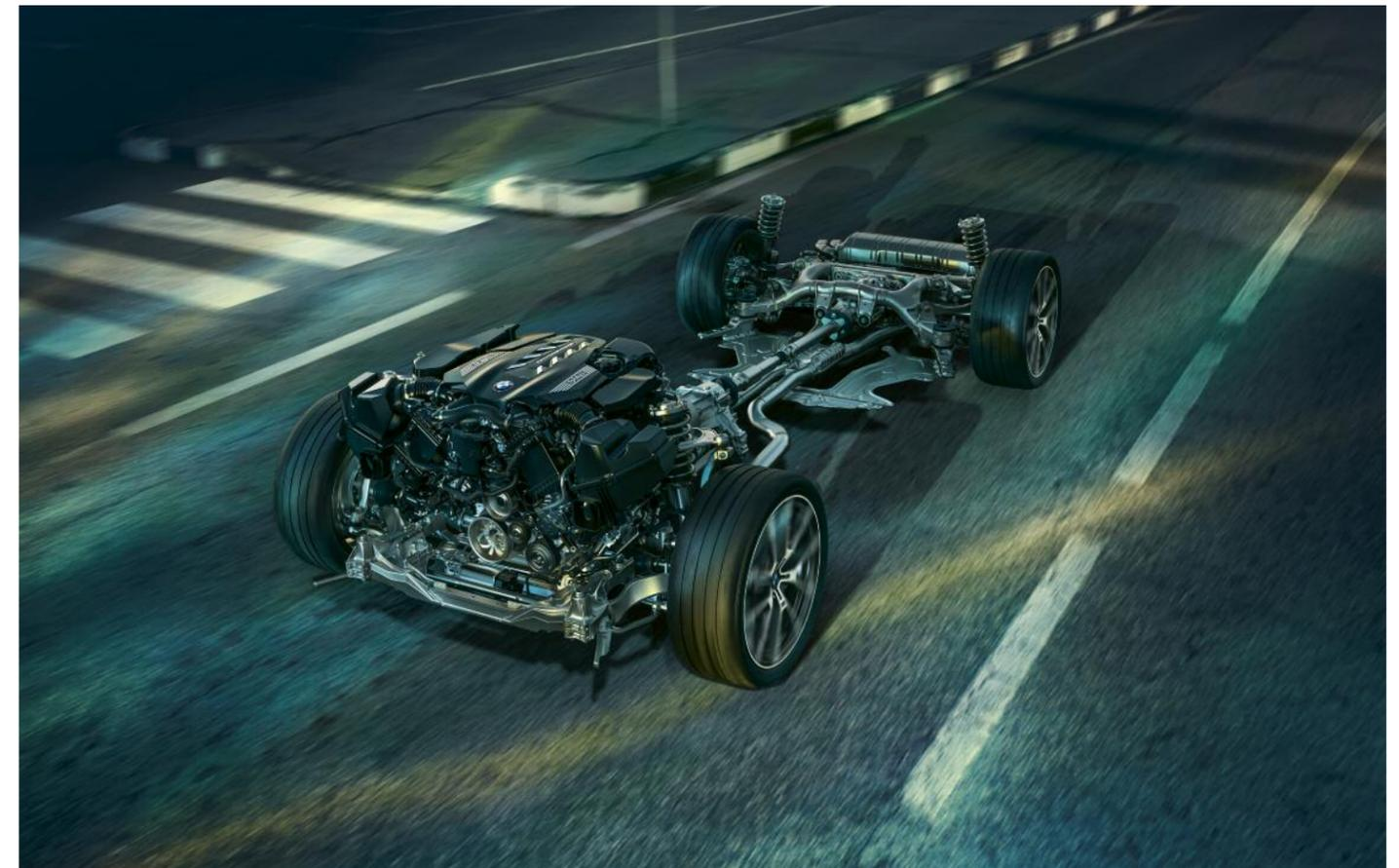
La direction ActiveDrive<sup>1</sup> à 4 roues directrices associe une démultiplication asservie à l'angle de braquage sur l'essieu avant à des roues arrière directrices. À faible vitesse, ces dernières braquent dans le sens inverse des roues avant afin de garantir un surcroît de maniabilité et d'agilité. À partir d'environ 60 km/h, les roues arrière braquent dans le même sens que les roues avant pour augmenter la stabilité et le confort.
