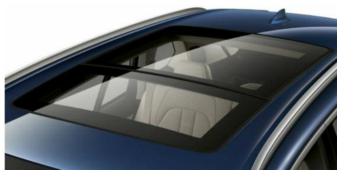
Ouvert, le **toit panoramique** en verre aère parfaitement l'habitacle. Fermé, il le baigne de lumière et garantit une atmosphère agréable. S'ouvrant et se refermant de manière entièrement automatique sur pression d'un bouton ou via la clé radiocommandée, coulissant et entrebâillable, il est doté d'un store pare-soleil et d'un déflecteur.
