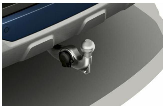
Le dispositif d'attelage avec rotule escamotable électriquement est homologué pour un poids remorquable maximal de 3 500 kg. Le système de stabilisation de l'attelage freine automatiquement le véhicule en cas de mouvement de roulis de la remorque. Non utilisé, le crochet s'escamote électriquement à l'abri des regards, sous la jupe arrière.
