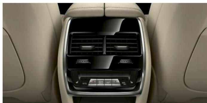
La climatisation automatique 4 zones inclut des fonctionnalités étendues en plus des fonctionnalités de la climatisation automatique 2 zones ainsi que deux aérateurs sur les montants centraux. Par ailleurs, les passagers arrière bénéficient d'un réglage individuel via une commande séparée avec affichage.
