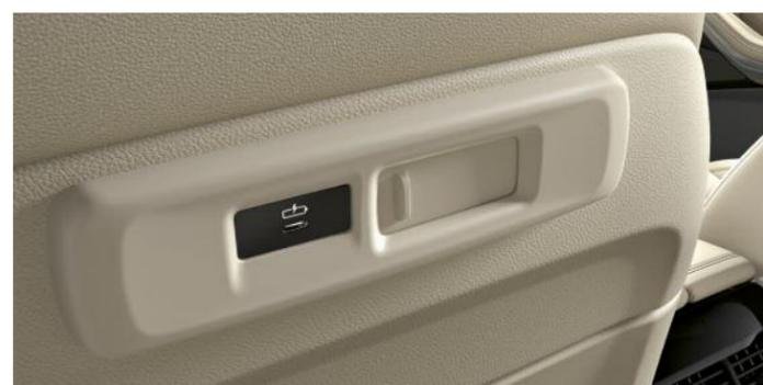
Avec deux prises USB (type C) supplémentaires et un courant de charge maximum de trois ampères dans les dossiers des sièges avant, les voyageurs installés à l'arrière ne manquent jamais d'énergie. Le **Travel & Comfort System** comprend également la préparation pour deux supports multifonctions à l'arrière du véhicule. Ces supports peuvent accueillir par ex. des tablettes, des cintres ou des tablettes aviation.
