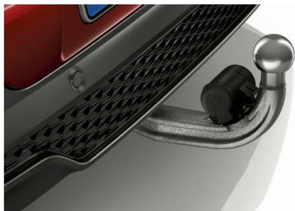
Le dispositif d'attelage avec rotule escamotable électriquement est homologué pour un poids remorquable élevé (jusqu'à 2 400 kg). Le système de stabilisation de l'attelage freine automatiquement le véhicule en cas de mouvement de roulis de la remorque. Non utilisé, le crochet s'escamote électriquement à l'abri des regards, sous la jupe arrière.
