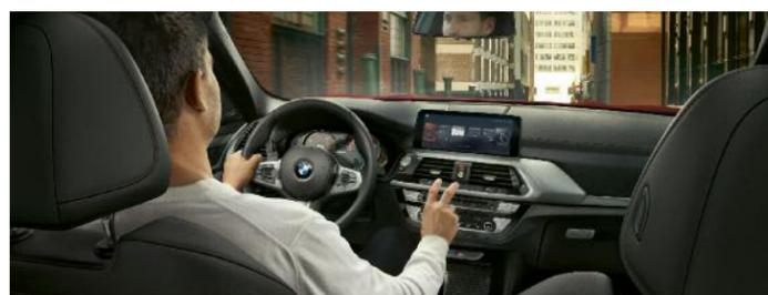
Grâce à la **commande gestuelle BMW**, il est possible de piloter certaines fonctions grâce à des mouvements précis de la main. Pour certaines commandes, le système reconnaît ainsi les gestes « balayer » ou « montrer », qui permettent notamment d'accepter ou de rejeter un appel entrant, ou encore de régler le volume sonore. Pour régler le volume sonore, il suffit d'effectuer un mouvement rotatif avec l'index.
