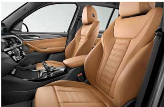
Les sièges Advanced pour conducteur et passager avant à réglages individuels se distinguent par de nombreux réglages manuels, par exemple pour la largeur du dossier, la longueur de l'assise, ainsi que l'inclinaison du dossier et de l'assise. Grâce aux flancs de l'assise et du dossier plus hauts et aux flancs latéraux généreux, ils offrent une ergonomie et un maintien latéral exceptionnels.
