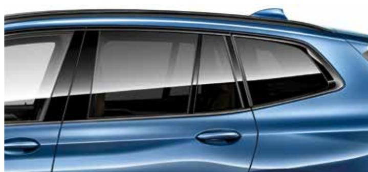
Le **vitrage calorifuge** pour la lunette arrière et les vitres latérales arrière foncées réduit le réchauffement de l'habitacle. Un vitrage teinté plus foncé à partir des montants centraux assure une meilleure absorption des rayons du soleil. La teinte foncée des vitres n'obstrue pas la visibilité de l'intérieur vers l'extérieur, mais protège des regards indiscrets.
