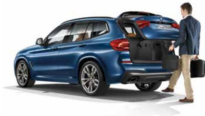
L'Accès Confort permet d'ouvrir les quatre portes sans manipuler la clé. L'équipement comprend notamment l'ouverture/fermeture sans contact du coffre « Smart Opener » d'un mouvement rapide du pied sous le bouclier arrière.
