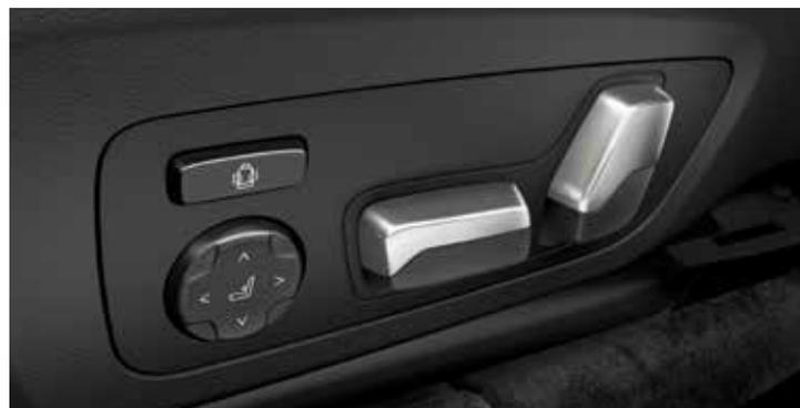
L'option **Sièges avant électriques** permet d'amener aisément les sièges dans les positions souhaitées. La fonction mémoire permet d'activer à tout moment sur pression d'un bouton les réglages personnalisés pour le siège conducteur et les rétroviseurs extérieurs. De plus, le réglage en hauteur de l'Affichage Tête Haute HUD optionnel est couplé à l'ajustement de la position du siège.
