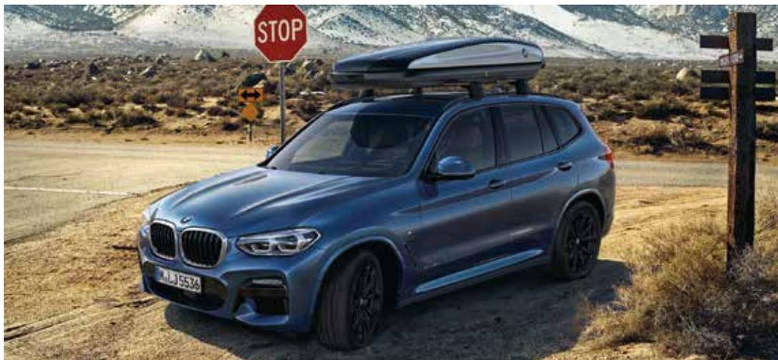
○ Le **coffre de toit** moderne en « Schwarz » avec inserts latéraux en « Titan-silber » affiche une capacité de 520 litres et est compatible avec tous les systèmes de portage sur toit BMW. Pouvant être ouvert des deux côtés, ce qui permet de le remplir facilement, il comporte une fermeture antivol centralisée à 3 points des deux côtés.
