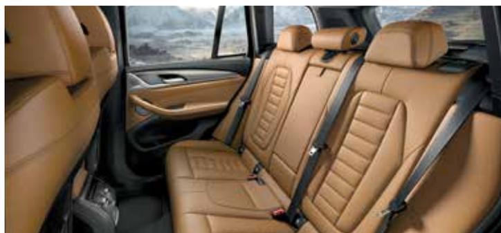
Un levier placé sur les sièges arrière gauche et droit permet de modifier l'**inclinaison des dossiers** de cinq degrés vers l'avant et six degrés vers l'arrière. Les passagers arrière peuvent ainsi adapter leur position d'assise en fonction de leurs préférences. De plus, la possibilité de réglage facilite le transport d'objets encombrants dans le compartiment à bagages.
