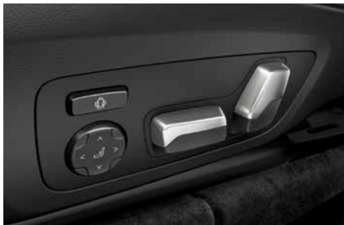
L'option Sièges avant électriques permet d'amener aisément les sièges dans les positions souhaitées. La fonction mémoire permet d'activer à tout moment sur pression d'un bouton les réglages personnalisés pour le siège conducteur et les rétroviseurs extérieurs. De plus, le réglage en hauteur de l'Affichage Tête Haute HUD est couplé à l'ajustement de la position du siège.
