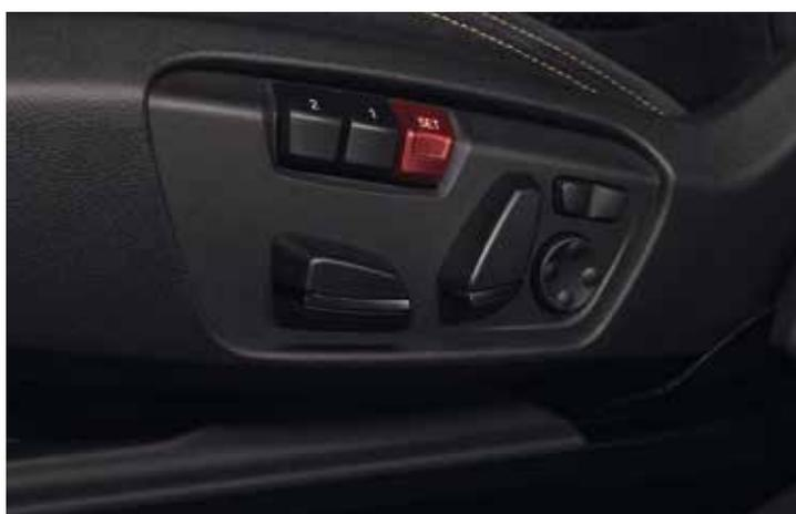
La fonction **Sièges avant électriques** permet d'amener aisément les sièges avant dans les positions souhaitées. La fonction mémoires conducteur permet, de son côté, d'enregistrer les réglages souhaités pour le siège conducteur et les rétroviseurs extérieurs et de les réactiver par la suite à tout moment d'une simple pression sur un bouton.
