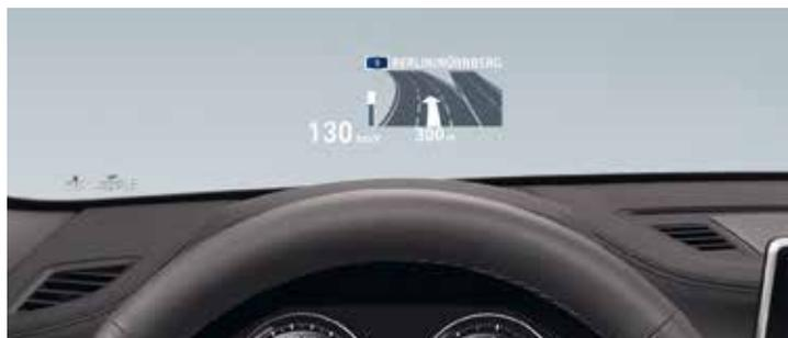
L'**Affichage Tête Haute HUD** couleur affiche, par le biais d'un système de projection optique, les informations importantes pour la conduite dans le champ de vision du conducteur pour lui permettre de rester concentré sur la route. La vitesse instantanée, les instructions de navigation, l'indicateur de limitation de vitesse avec interdiction de dépassement ainsi que les listes de contacts téléphoniques et de contenus média sont notamment affichés.
