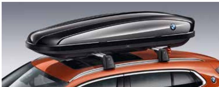
○ **Coffre de toit** d'origine BMW avec un volume de chargement de 420 litres et un chargement maximal de 50 kg. Son design est assorti au coffre de toit 520 récompensé par le Red Dot design award. Il présente un couvercle noir brillant avec caches latéraux argent titane et sigle BMW.
