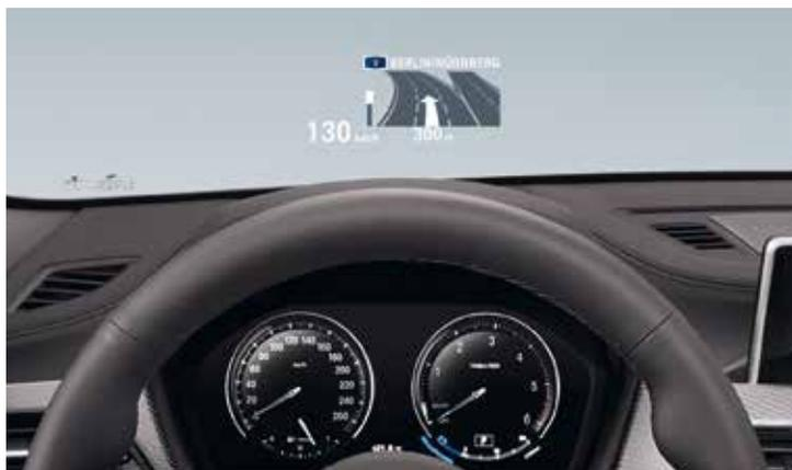
L'**Affichage Tête Haute HUD** couleur affiche, par le biais d'un système de projection optique, les informations importantes pour la conduite dans le champ de vision du conducteur pour lui permettre de rester concentré sur la route. La vitesse instantanée, les instructions de navigation, l'indicateur de limitation de vitesse avec interdiction de dépassement ainsi que les listes de contacts téléphoniques et de contenus média sont notamment affichés.
