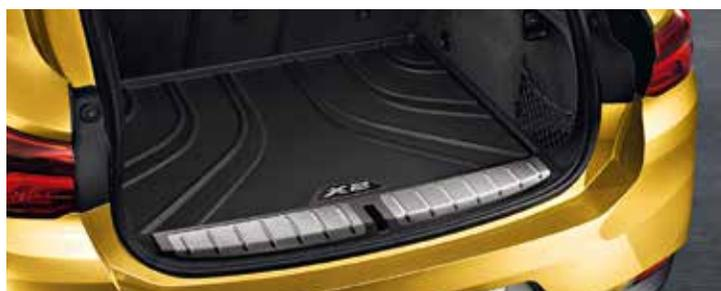
○ De forme ajustée, antidérapant, étanche et résistant, le **tapis à bords hauts du coffre à bagages.** En « Schwarz », avec incrustation en acier du chiffre X2.
