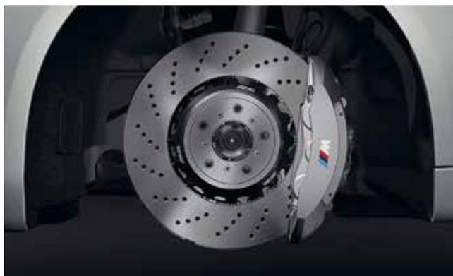
**Système de freinage renforcé**, étriers perforés 6 pistons de 40 mm à l'avant et 4 pistons de 38 mm à l'arrière. Ils se distinguent par leurs étriers peints en gris et arborant un badge M. Le système augmente les performances de freinage, l'endurance et assure une excellente résistance à la chaleur et à l'usure.
