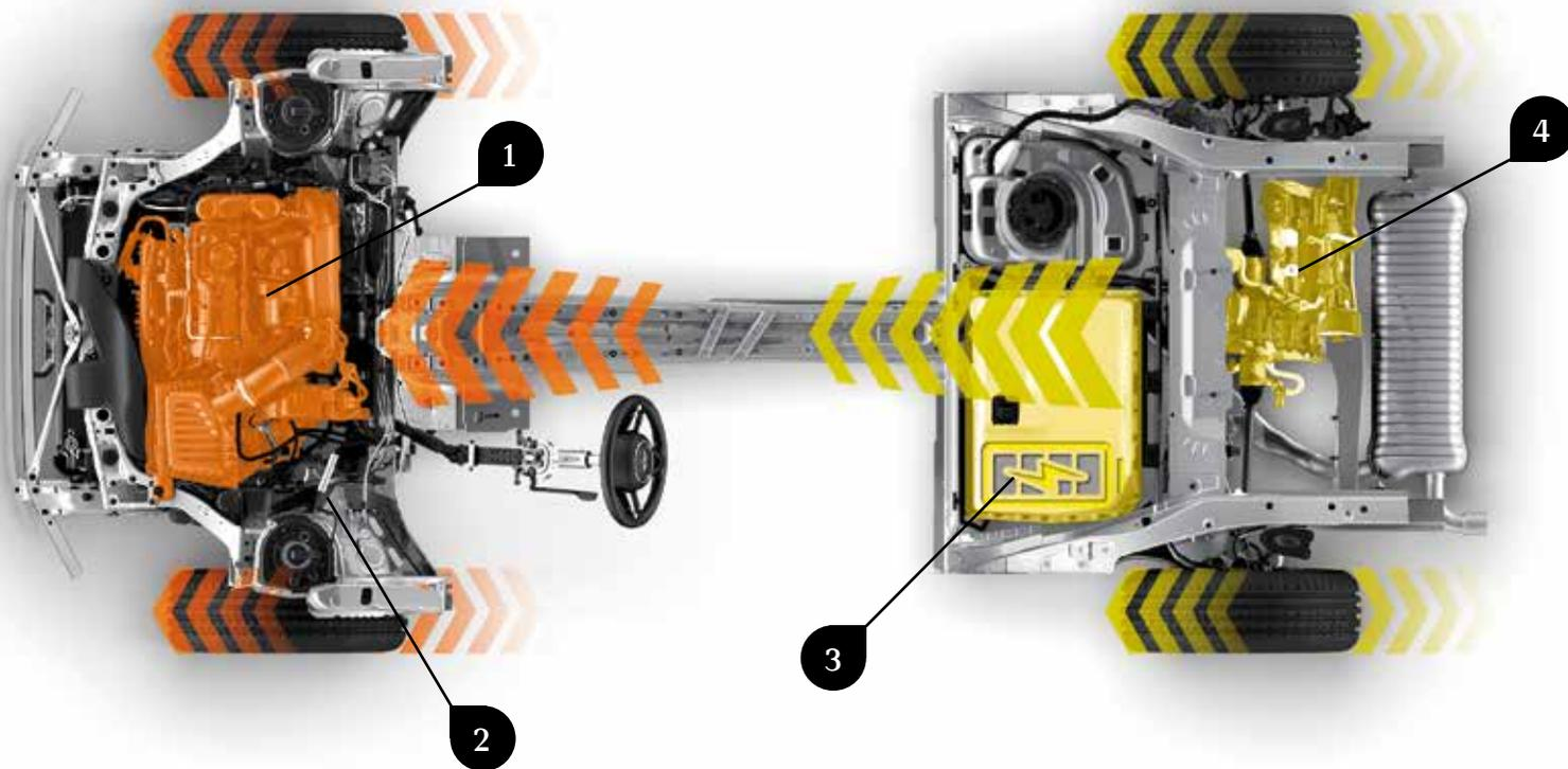
Le système hybride rechargeable gère automatiquement l'interaction entre le moteur thermique **1** et électrique **4**.
