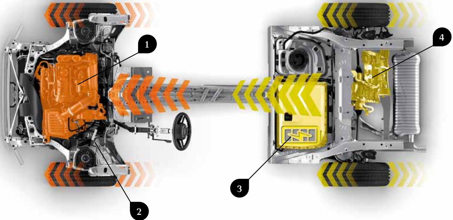
Le système hybride rechargeable gère automatiquement l'interaction entre le moteur thermique **1** et électrique **4**. Couplé à la boîte de vitesses automatique à 6 rapports **2**, le moteur essence de 136 ch entraîne les roues avant. Le moteur électrique de 88 ch entraîne les roues arrière afin de procurer une transmission intégrale e-ALL4. La batterie haute tension **3**, située sous la banquette arrière, stocke l'énergie nécessaire au moteur électrique.
