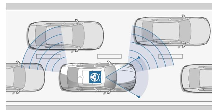
L'**Avertisseur de franchissement de ligne** détecte les marquages au sol à partir d'environ 70 km/h et prévient le conducteur par une vibration du volant si la voiture menace de quitter sa voie. Si le clignotant est enclenché, signe d'un changement de voie délibéré, l'alerte ne se déclenche pas.
