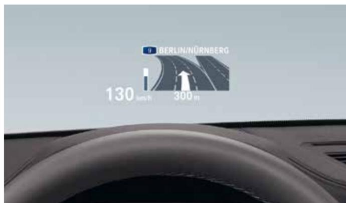
L'**Affichage Tête Haute HUD** couleur affiche, par le biais d'un système de projection optique, les informations importantes pour la conduite dans le champ de vision du conducteur pour lui permettre de rester concentré sur la route. La vitesse instantanée, les instructions de navigation, l'indicateur de limitation de vitesse avec interdiction de dépassement ainsi que les listes de contacts téléphoniques et de contenus média sont notamment affichés.
