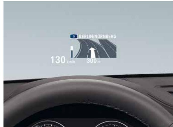
L'**Affichage Tête Haute HUD** couleur affiche, par le biais d'un système de projection optique, les informations importantes pour la conduite dans le champ de vision du conducteur pour lui permettre de rester concentré sur la route. La vitesse instantanée, les instructions de navigation, l'indicateur de limitation de vitesse avec interdiction de dépassement ainsi que les listes de contacts téléphoniques et de contenus média sont notamment affichés.
