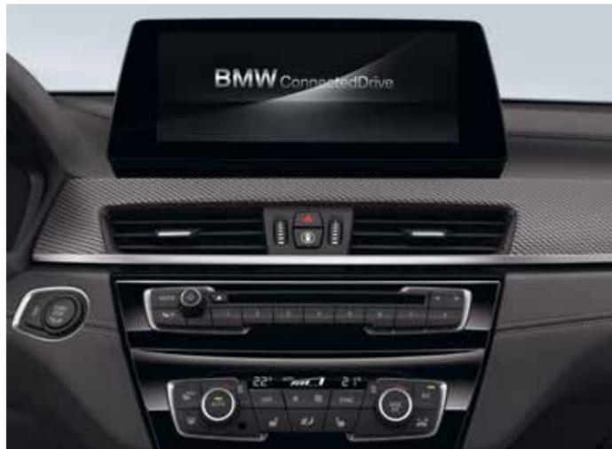
La **Navigation multimédia Professional** dispose d'un Affichage Tête Haute HUD, d'un « Contrôler » iDrive Touch, d'un écran tactile fixe de 10,25" (26 cm) et d'un combiné d'instrumentation avec écran TFT haute résolution 5,7" (14,5 cm). Le système se pilote intuitivement par le biais du « Contrôler » iDrive Touch, des touches d'accès direct et des 8 touches de raccourci, de la commande vocale ou de l'écran tactile avec tuiles interactives.
