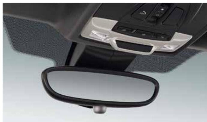
Le **rétroviseur intérieur électrochrome** évite au conducteur d'être ébloui par les projecteurs des véhicules qui suivent en s'obscurcissant automatiquement à partir d'une certaine incidence de la lumière.
