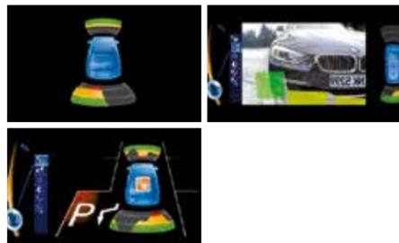
Facilite les créneaux. Les places de stationnement suffisamment grandes s'affichent sur l'écran de contrôle et peuvent être sélectionnées.
