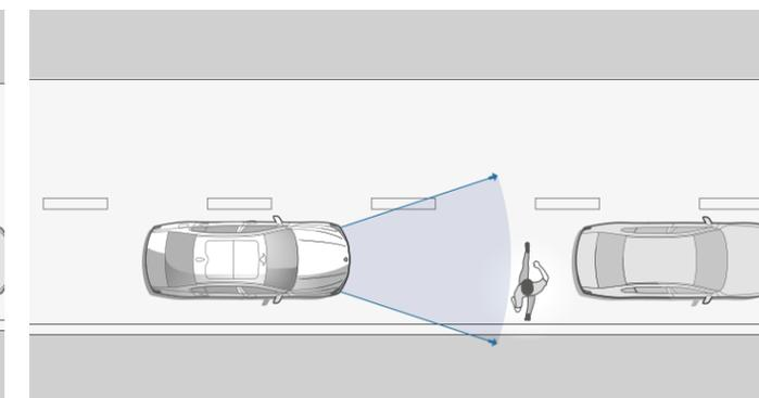
La **Protection active des piétons et Système anti-collision** à basse vitesse assiste le conducteur activement en évitant les collisions avec les piétons. Jusqu'à une vitesse de 60 km/h, il avertit le conducteur tout en préconditionnant les freins pour une réactivité maximale. En cas d'urgence, le système empêche une collision ou assure une nette diminution de la vitesse de collision.
