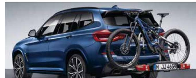
○ Léger et robuste à la fois, le **porte-vélos** Pro 2.0 supporte jusqu'à 60 kg. Très facile à manipuler, il peut transporter jusqu'à deux vélos/vélos électriques (extensible à trois vélos). Sa fonction de basculement garantit à tout moment l'accès au compartiment à bagages.
