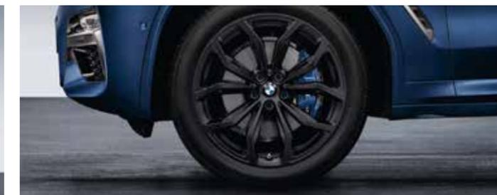
○ Les jantes haut de gamme en alliage léger 20» (51 cm) style 695 à rayons en Y sont en noir mat, avec deux rangées de rayons. Roues complètes été avec monte pneumatique mixte RSC permettant le roulage à plat. Dimensions : 8 J x 20 à l'avant, pneumatiques 245/45 R20 103W XL RSC ; 9,5 J x 20 à l'arrière, pneumatiques 275/40 R20 106W XL RSC. Disponibles également en tant que roues complètes hiver.
