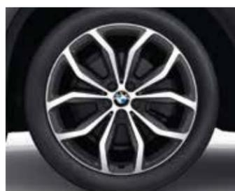
□ Jantes en alliage 20» style 695 à rayons en Y avec pneumatiques mixtes 8 J x 20 / pneus 245/45 R 20, 9,5 J x 20 / pneus 275/40 R 20
