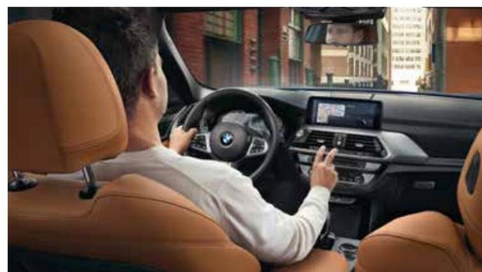
Grâce à la **commande gestuelle BMW**, il est possible de piloter certaines fonctions grâce à des mouvements précis de la main. Pour certaines commandes, le système reconnaît ainsi les gestes « balayer » ou « montrer », qui permettent notamment d'accepter ou de rejeter un appel entrant, ou encore de régler le volume sonore. Pour régler le volume sonore, il suffit d'effectuer un mouvement rotatif avec l'index.
