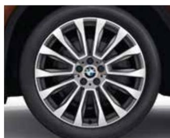
□ Jantes en alliage 20» style 697 à rayons en V avec pneumatiques mixtes 8 J x 20 / pneus 245/45 R 20, 9,5 J x 20 / pneus 275/40 R 20
