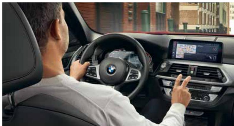
Grâce à la **commande gestuelle BMW**, il est possible de piloter certaines fonctions grâce à des mouvements précis de la main. Pour certaines commandes, le système reconnaît ainsi les gestes « balayer » ou « montrer », qui permettent notamment d'accepter ou de rejeter un appel entrant, ou encore de régler le volume sonore. Pour régler le volume sonore, il suffit d'effectuer un mouvement rotatif avec l'index.
