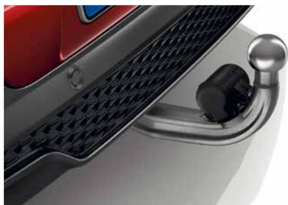
Le dispositif d'attelage avec rotule escamotable électriquement est homologué pour un poids remorquable élevé (jusqu'à 2 400 kg).
