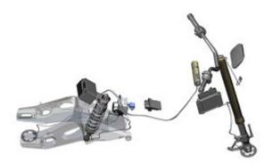
Quant à l'option configurable départ usine Dynamic ESA Pro, elle possède deux modes d'amortissement (Road, Dynamic) et la compensation de la charge est automatique. De plus, Dynamic ESA Pro offre un réglage dit « Min » pour une précontrainte minimum du ressort qui contribue à la position de conduite la plus basse possible, ce qui peut présenter des avantages par exemple lors du redressement de la machine lorsqu'un passager est à bord.
