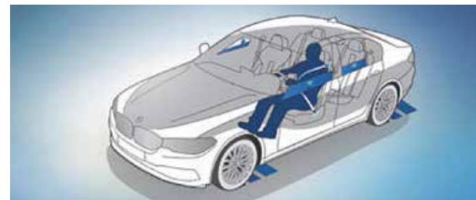
La **Protection active** des occupants est un système de sécurité préventif signé BMW ConnectedDrive. Elle prévient le conducteur en cas de fatigue ; dans les situations critiques, les ceintures de sécurité sont pré-tendues, le dossier des sièges à réglages électriques est redressé, les vitres et le toit ouvrant sont fermés. Après un accident, le système freine automatiquement la voiture jusqu'à l'arrêt.
