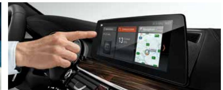
Grâce à la **commande gestuelle BMW**, il est possible de piloter certaines fonctions grâce à des mouvements précis de la main. Pour certaines commandes, le système reconnaît ainsi les gestes «balayer» ou «montrer», qui permettent notamment d'accepter ou de rejeter un appel entrant, ou encore de régler le volume sonore. Pour régler le volume sonore, il suffit d'effectuer un mouvement rotatif avec l'index.
