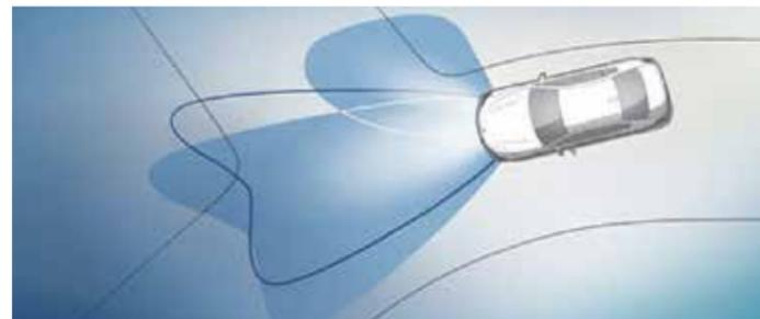
Les **projecteurs directionnels à LED avec répartition variable** de la lumière en ville et sur autoroute et feux de route permanents anti-éblouissement «BMW Selective Beam» assurent un éclairage optimal de l'achèvement. L'éclairage d'intersection compris dans l'équipement s'active automatiquement, même à l'arrêt, dès que le clignotant est actionné ou à partir d'un certain angle de rotation du volant et ce jusqu'à une vitesse de 35 km/h.
