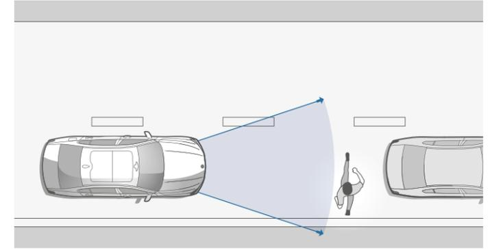
La **Protection active des piétons et Système anti-collision à basse vitesse** évite les collisions avec les piétons : jusqu'à 60 km/h, il avertit le conducteur tout en pré-conditionnant les freins pour une réactivité maximale. En cas d'urgence, le système empêche une collision ou assure une nette diminution de la vitesse de collision.
