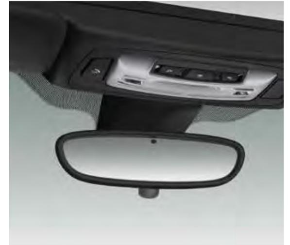
**Les rétroviseurs intérieur et extérieur côté conducteur** s'obscurcissent automatiquement. De son côté, le rétroviseur extérieur droit est doté d'une fonction "guide-trottoir" de basculement automatique vers le bas au passage de la marche arrière. Les deux rétroviseurs extérieurs sont rabattables électriquement et dotés d'une fonction mémoire. Cela facilite les manoeuvres de stationnement et évite d'endommager le véhicule.
