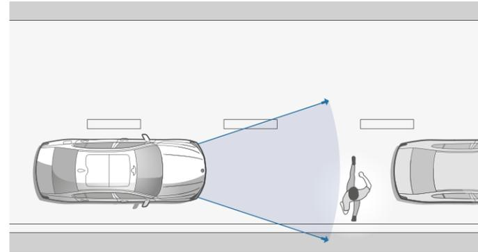
**La Protection active des piétons et Système anti-collision à basse vitesse** évitant les collisions avec les piétons. Jusqu'à une vitesse de 60 km/h, il avertit le conducteur tout en préconditionnant les freins pour une réactivité maximale. En cas d'urgence, le système empêche une collision ou assure une nette diminution de la vitesse de collision.
