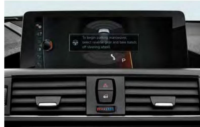
**Le système de manoeuvres automatiques "Park Assist"** facilite vos créneaux. Lorsque vous roulez à vitesse réduite, il mesure l'écart entre 2 voitures garées. Dès qu'il repère une place suffisamment grande, le système se charge alors de tourner le volant en indiquant au conducteur quand freiner ou passer les vitesses.
