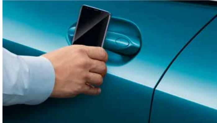
L'**Accès Confort** permet d'ouvrir les portes conducteur et passager et de démarrer le véhicule sur pression d'un bouton sans avoir à sortir la clé de la poche. La clé numérique Digital Key peut également être utilisée pour accéder au véhicule et le démarrer.
