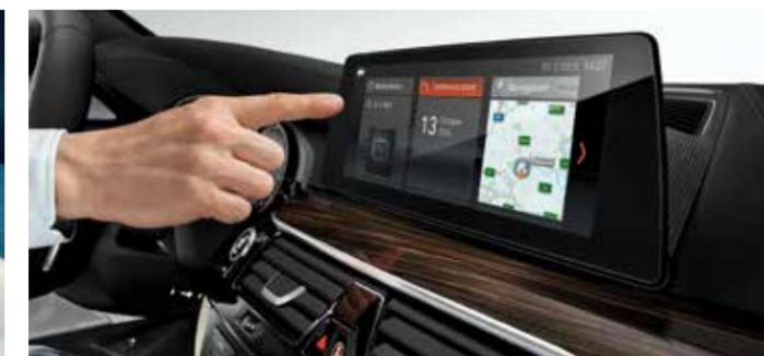
Grâce à la **commande gestuelle BMW**, il est possible de piloter certaines fonctions grâce à des mouvements précis de la main. Pour certaines commandes, le système reconnaît ainsi les gestes «balayer» ou «montrer», qui permettent notamment d'accepter ou de rejeter un appel entrant, ou encore de régler le volume sonore. Pour régler le volume sonore, il suffit d'effectuer un mouvement rotatif avec l'index.
