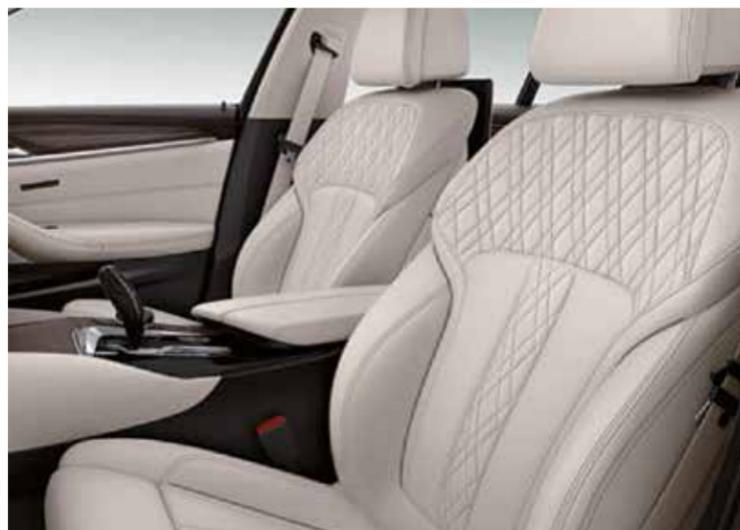
Les sièges Advanced Comfort pour conducteur et passager avant, avec appuis-tête actifs, sont dotés de nombreux réglages électriques.
