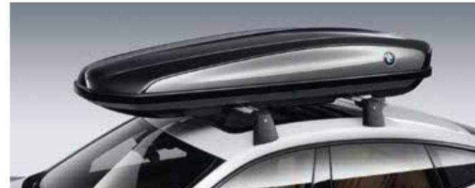
○ Le **coffre de toit moderne** en « Schwarz » avec inserts latéraux en « Titansilber » affiche une capacité de 520 litres et est compatible avec tous les systèmes de portage sur toit BMW. Pouvant être ouvert des deux côtés, ce qui permet de le remplir facilement, il comporte une fermeture antivol centralisée à 3 points des deux côtés.
