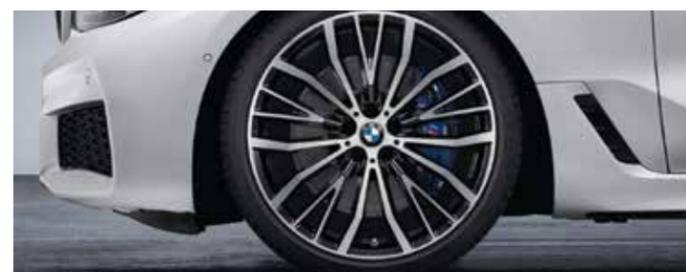
○ Les jantes haut de gamme en alliage léger 21" (53 cm) sont bicolores « Schwarz » et polies, avec base de jante laminée et au poids optimisé. Jeu de roues complètes avec monte pneumatique mixte RSC permettant le roulage à plat.
