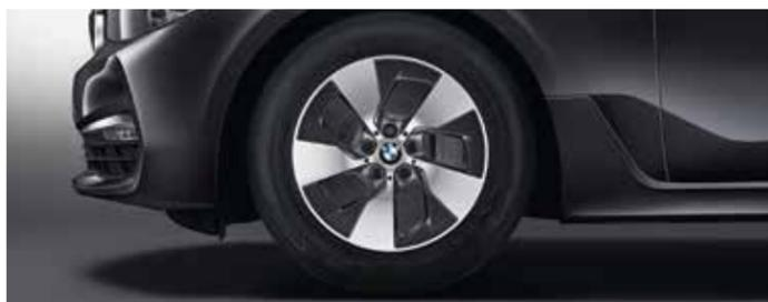
□ Les jantes en alliage léger 17" (43 cm) style 645 turbine bicolores (dimensions : 7,5 J x 17, pneumatiques 225/60 R 17) permettent d'économiser du carburant et de réduire les émissions de CO<sub>2</sub>.
