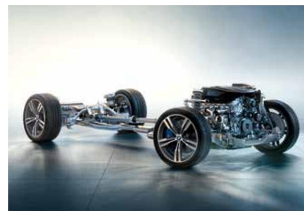
Système de régulation des trains roulants associant un grand confort de conduite à d'excellentes qualités dynamiques. Il est basé sur la direction ActiveDrive à 4 roues directrices et des stabilisateurs actifs qui assurent une régulation électromécanique en continu et minimisent ainsi l'inclinaison de la carrosserie.
