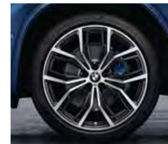
○ Jantes BMW M Performance en **alliage léger 21"** (53 cm) style 701 M à rayons en Y bicolores. Roues complètes été avec monte pneumatique mixte RSC permettant le roulage à plat.
