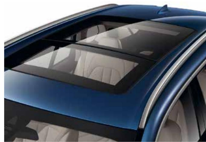
Ouvert, le **toit panoramique** en verre aère parfaitement l'habitacle. Fermé, il le baigne de lumière. Ouverture entièrement automatique via un bouton ou la clé radiocommandée. Coulissant et entrebâillable, il est doté d'un store pare-soleil et d'un déflecteur.
