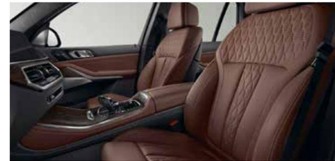
Chauffage de l'assise et du dossier des sièges avant et arrière latéraux, réglable sur 3 niveaux.
