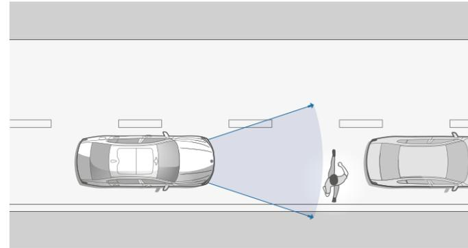
La **Protection active des piétons et Système anti-collision** à basse vitesse assiste le conducteur activement en évitant les collisions avec les piétons. Jusqu'à une vitesse de 60 km/h, il avertit le conducteur tout en pré-conditionnant les freins pour une réactivité maximale. En cas d'urgence, le système empêche une collision ou assure une nette diminution de la vitesse de collision. Le fonctionnement du système peut être limité dans l'obscurité ou en présence de brouillard.
