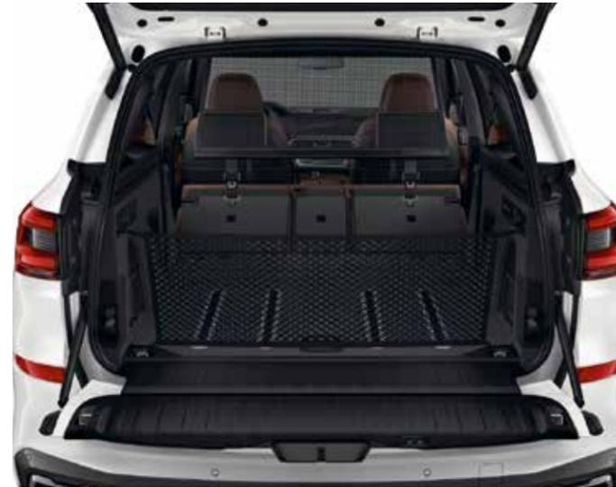
Le **Pack Compartiment à bagages\*** comprend un filet de rangement, des rails coulissants et antidérapants automatisés, un filet souple et un cache bagages coulissant électriquement horizontalement et verticalement. Il se range dans le plancher du coffre sous un rabat automatiquement. \*Comprend uniquement un filet de rangement et un filet souple sur xDrive45e et en relation avec le pack 7 places.
