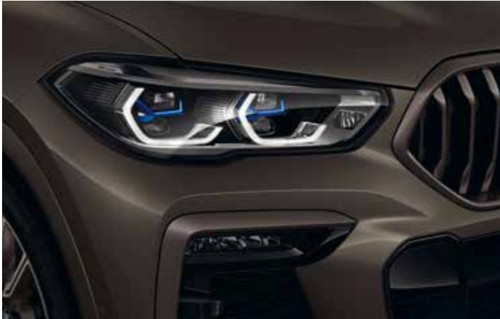
Projecteurs Laser BMW En mode feux de route, les projecteurs Laser BMW portent jusqu'à 500 mètres, soit presque deux fois plus loin que des projecteurs traditionnels. Cette amélioration de la visibilité dans l'obscurité représente un gain très net de sécurité. La signature X bleue et l'inscription "BMW Laser" soulignent le haut niveau de technicité de la voiture.
