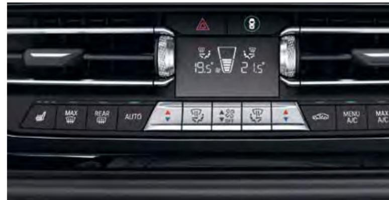
Avant même que le moteur n'ait atteint sa température de fonctionnement, les **sièges avant chauffants** dotés de trois niveaux de réglage permettent de bénéficier rapidement d'une chaleur agréable.
