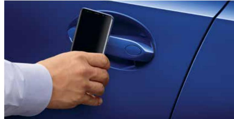
L'**Accès Confort** permet d'ouvrir les portes conducteur et passager et de démarrer le véhicule sur pression d'un bouton sans avoir à sortir la clé de la poche. La clé numérique Digital Key peut également être utilisée pour accéder au véhicule et le démarrer.
