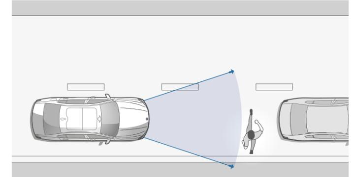
La **Protection active des piétons et Système anti-collision à basse vitesse** évite les collisions avec les piétons : jusqu'à 60 km/h, il avertit le conducteur tout en pré-conditionnant les freins pour une réactivité maximale.
