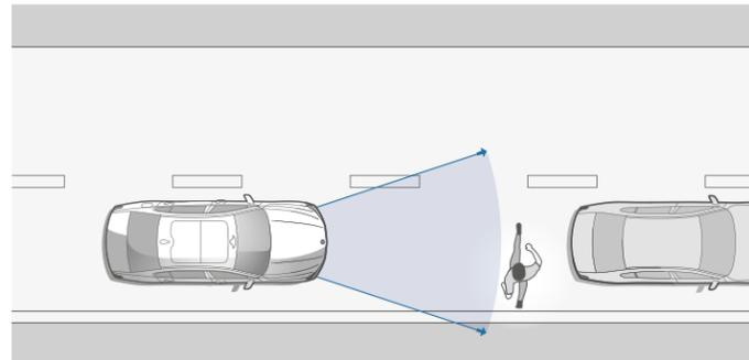
Protection active des piétons et Système anti-collision
