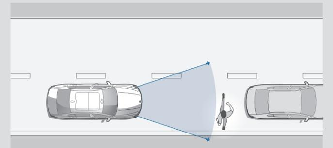
**L'Avertisseur de risque de collision avant avec fonction freinage** détecte les véhicules, la protection active des piétons réagit en cas de risque de collision avec des personnes. Les freins sont alors conditionnés pour une réactivité maximale. Si la collision est inévitable, le système déclenche un freinage maximal. Le système peut être limité dans l'obscurité ou en présence de brouillard.
