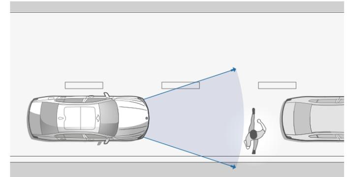
**La Protection active des piétons et Système anti-collision à basse vitesse** évitant les collisions avec les piétons. Jusqu'à une vitesse de 60 km/h, il avertit le conducteur tout en préconditionnant les freins pour une réactivité maximale. En cas d'urgence, le système empêche une collision ou assure une nette diminution de la vitesse de collision.
