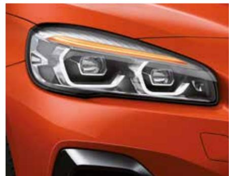
Les feux de route permanents anti-éblouissement "BMW Selective Beam", l'éclairage diurne et les projecteurs directionnels avec répartition variable de la lumière offrent un éclairage optimal de la chaussée et une meilleure visibilité dans l'obscurité.
