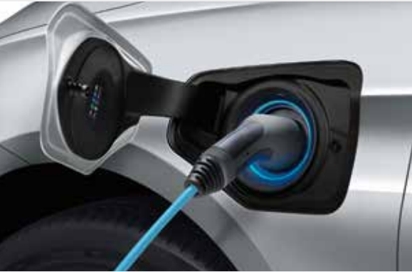
Une bague d'étanchéité spéciale protège la prise pour recharge externe. L'anneau lumineux à LED qui l'entoure indique le niveau de charge de la batterie.
