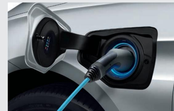
Une bague d'étanchéité spéciale protège la prise pour recharge externe. L'anneau lumineux à LED qui l'entoure indique le niveau de charge de la batterie.
