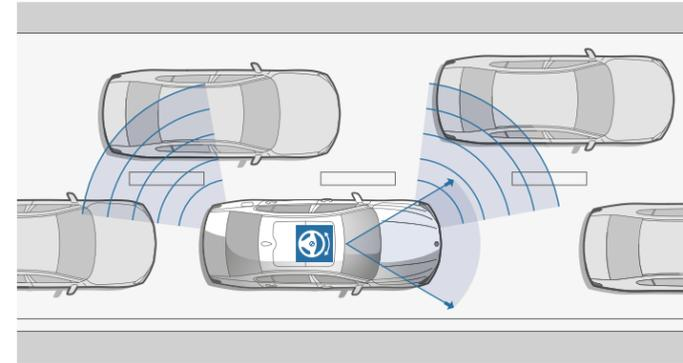
L'**Avertisseur de franchissement de ligne** détecte les marquages au sol à partir d'environ 70 km/h et prévient le conducteur par une vibration du volant si la voiture menace de quitter sa voie.
