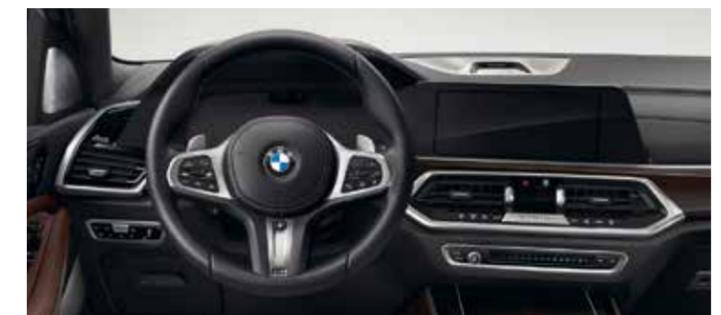
Outre les sièges avant chauffants, le Pack Chauffage Intégral inclut des accoudoirs chauffants dans les portières et sur la console centrale avant, ainsi qu'un volant chauffant.
