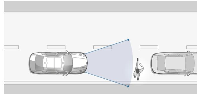
La Protection active des piétons et Système anti-collision avertit le conducteur jusqu'à une vitesse de 60 km/h et pré-conditionne les freins pour une réactivité maximale. En cas d'urgence, le système empêche une collision ou assure une nette diminution de la vitesse de collision.
