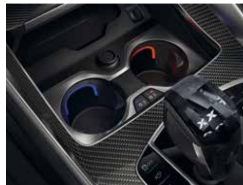
Les porte-boissons thermorégulés en console centrale, maintiennent les boissons au chaud ou au frais. L'éclairage d'ambiance signale la fonction activée, en bleu pour froid ou en rouge pour chaud.
