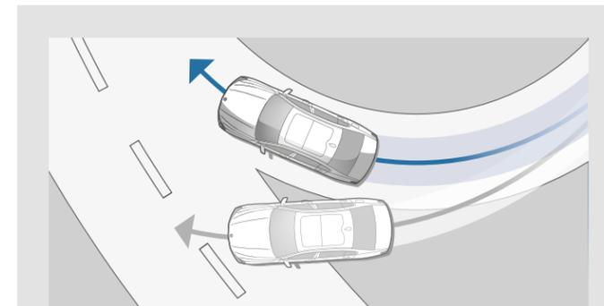
**Le Contrôle de la Transmission** intervient en courbe en transmettant davantage de couple aux roues extérieures au virage pour ralentir les roues intérieures. Résultat : une sécurité et un comportement dynamique améliorés.
