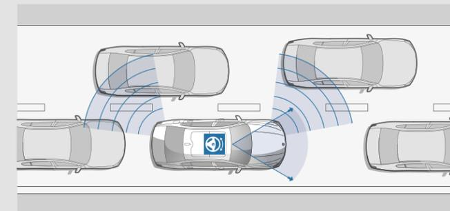
**L'Avertisseur de franchissement de ligne** reconnaît les lignes de délimitation des voies, détecte à partir d'environ 70 km/h tout risque de chevauchement de voie et en avertit le conducteur par des vibrations dans le volant.
