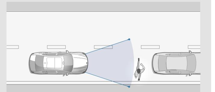
**L'Avertisseur de risque de collision avant avec fonction freinage** détecte les véhicules, la protection active des piétons réagit en cas de risque de collision avec des personnes. Les freins sont alors conditionnés pour une réactivité maximale. Si la collision est inévitable, le système déclenche un freinage maximal. Le système peut être limité dans l'obscurité ou en présence de brouillard.
