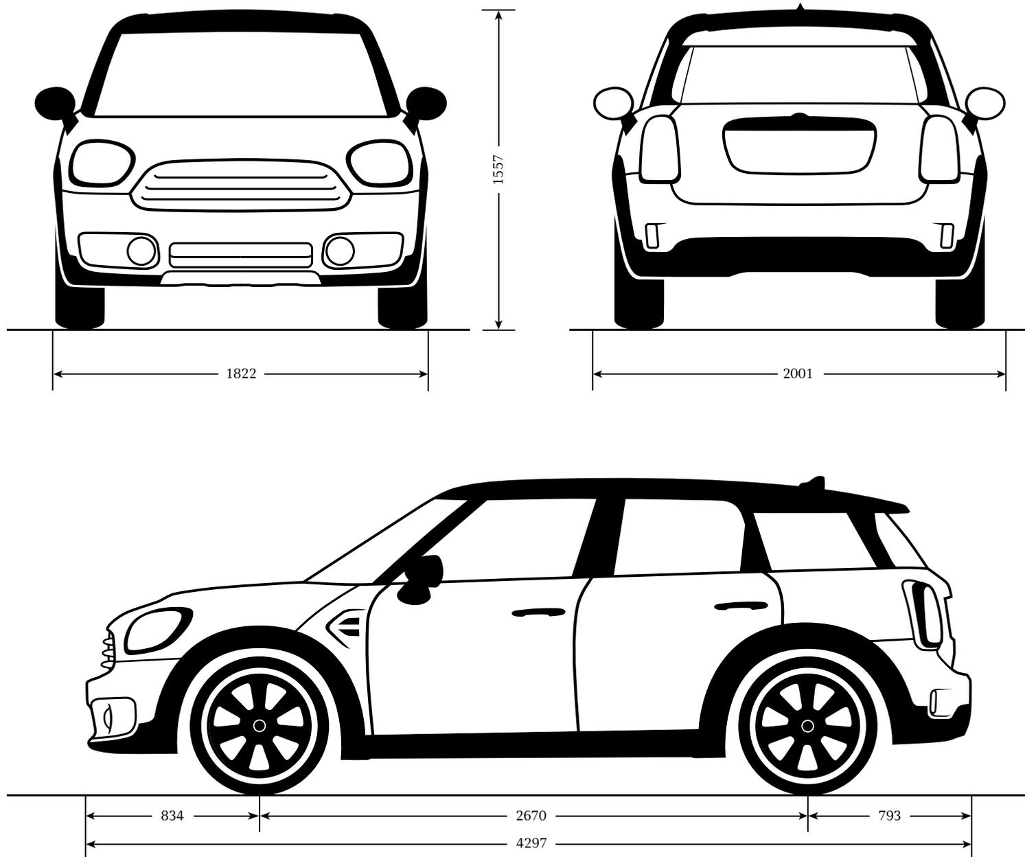
Largeur des voies sur Cooper S et Cooper SD : 1 563 à l'avant, 1 565 à l'arrière. Toutes les données sont en mm.
