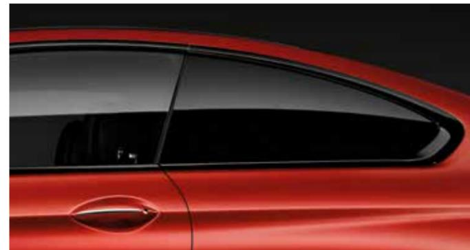
**Le vitrage calorifuge** pour la lunette arrière et les vitres latérales arrière (foncées) réduit le réchauffement de l'habitacle.
