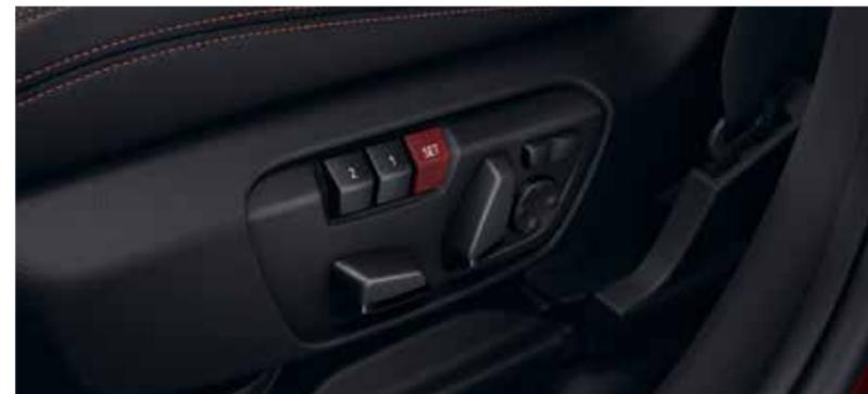
Vous pouvez régler aisément **les sièges avant électriques** et enregistrer les positions du siège conducteur et des rétroviseurs extérieurs grâce à la fonction mémoire.
