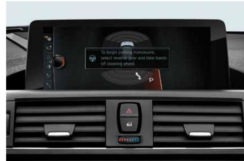
**Le système de manœuvres automatiques "Park Assist"** facilite vos créneaux. Lorsque vous roulez à vitesse réduite, il mesure l'écart entre 2 voitures garées. Dès qu'il repère une place suffisamment grande, le système se charge alors de tourner le volant en indiquant au conducteur quand freiner ou passer les vitesses.
