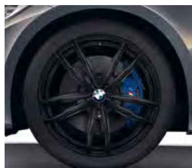
19" Jantes alliage léger style 791 M Jet Black Pneumatiques : Avant : 225/40 R19 Arrière : 255/35 R19
