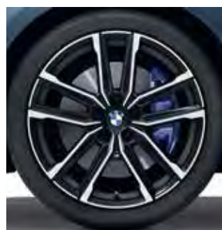
19" Jantes alliage léger M style 797 M bicolores Jet Black Pneumatiques : Avant : 225/40 R19 Arrière : 255/35 R19
