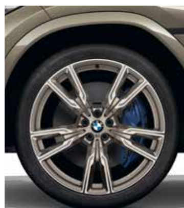
Alliage léger 22" style 747 M bicolores à rayons en V. Pneumatiques mixtes : 9,5 J x 22 / pneus 275/35 R 22 / 10,5 J x 22 / pneus 315/30 R 22
