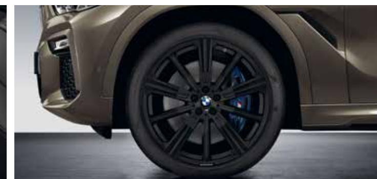
Jeu de roues été complètes M Performance La jante en alliage léger 22" M Performance à rayons en étoile style 749 M associe la légèreté aux performances sportives et à un design extraordinaire. Grâce à un procédé de fabrication spécial, cette jante en alliage léger avec base de jante laminée est plus légère d'environ 1,0 kg qu'une jante moulée de style comparable pour la même dimension.
