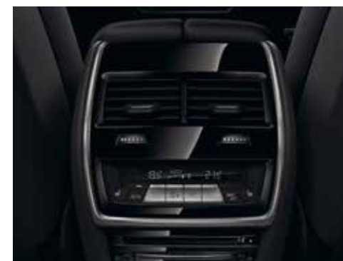
Le chauffage des sièges chauffe l'assise et le dossier des sièges avant et des sièges arrière latéraux, la température étant réglable sur trois niveaux et séparément pour chaque siège.
