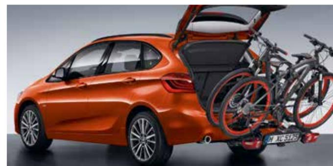
**Porte-vélos électriques** pour le transport de trois vélos (max. 60 kg), kit d'extension disponible pour un troisième vélo. Montage en toute sécurité sur le crochet d'attelage. Peut être rabattu pour faciliter l'accès au compartiment à bagages.
