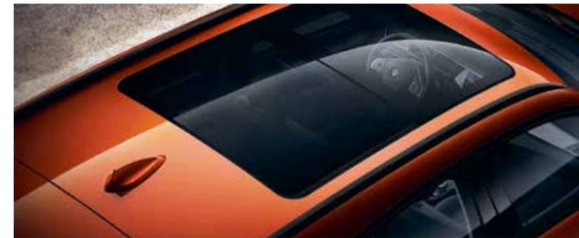
**Le toit ouvrant électrique** en verre coulissant et entrebâillable permet de réguler le débit d'air individuellement, sans courant d'air et ni bruit importants.
