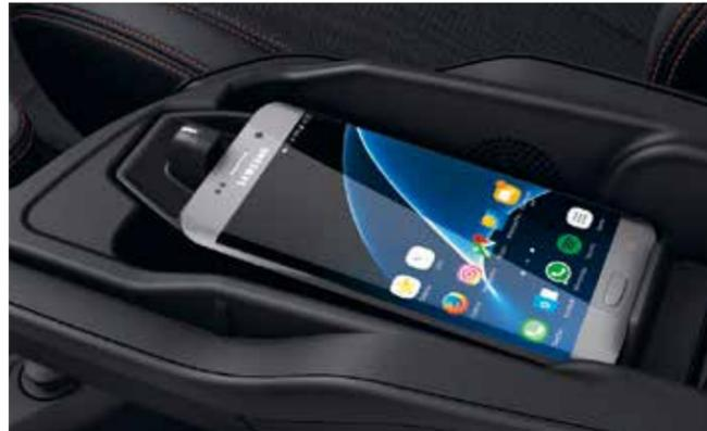
**La connectivité avancée sans fil avec recharge par induction** propose un pack de téléphonie complet avec Bluetooth et préparation pour hotspot Wi-Fi.
