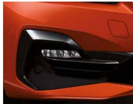
En cas de brouillard ou de pluie, les projecteurs antibrouillard à LED offrent une luminosité proche de la lumière du jour.
