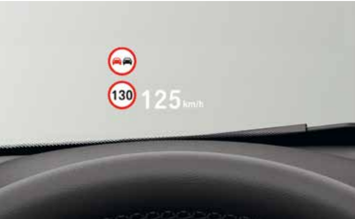
L'Affichage Tête Haute BMW affiche, par le biais d'un système de projection optique, toutes les informations importantes pour la conduite dans le champ de vision du conducteur.
