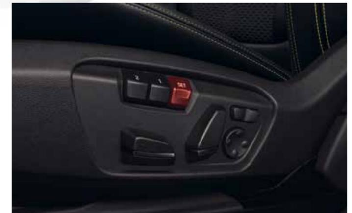
La fonction **Sièges avant électriques** permet d'amener aisément les sièges avant dans les positions souhaitées. La fonction mémoires conducteur permet, de son côté, d'enregistrer les réglages souhaités pour le siège conducteur et les rétroviseurs extérieurs et de les réactiver par la suite à tout moment d'une simple pression sur un bouton.
