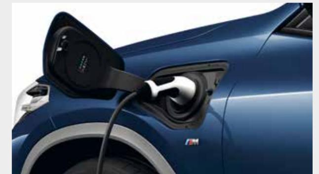
Une bague d'étanchéité spéciale protège la **prise pour recharge externe**. L'anneau lumineux à LED qui l'entoure indique le niveau de charge de la batterie.
