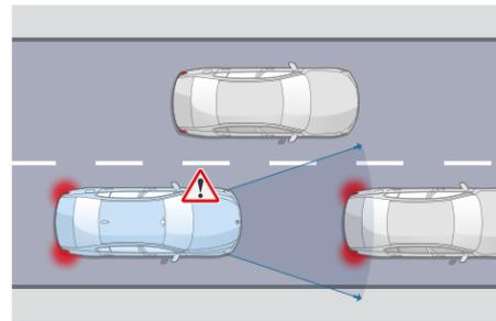
**Détection de collision avant avec freinage**
