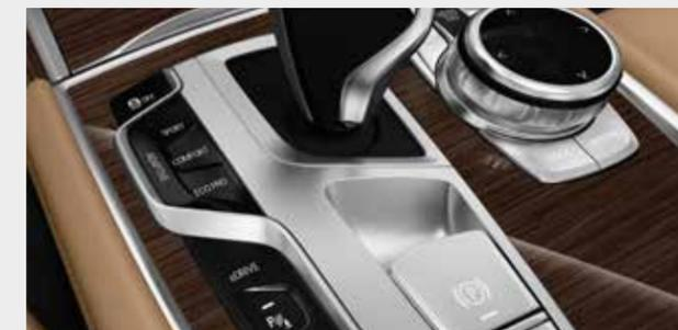
Les touches de sélection de mode de conduite vous permettent de sélectionner le mode de fonctionnement du système hybride :
