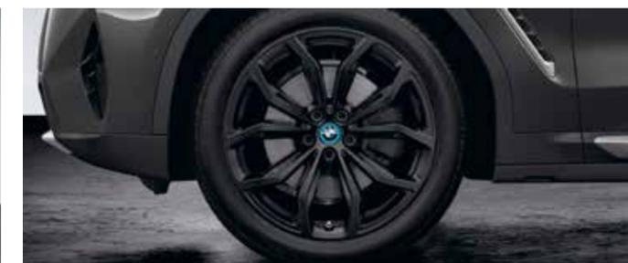
○ Les jantes haut de gamme en alliage léger 20" (51 cm) style 695 à rayons en Y sont en noir mat, avec deux rangées de rayons. Roues complètes été avec monte pneumatique mixte RSC permettant le roulage à plat
