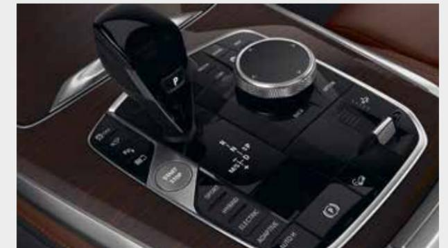
**La touche e-Drive** vous permet de sélectionner le mode de fonctionnement du système hybride :
