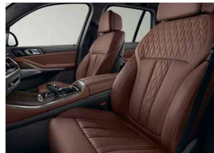
Le **pack chauffage intégral avant** chauffe les sièges et les accoudoirs avant ainsi que le volant.
