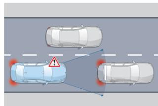
**Détection de collision avant avec freinage**
