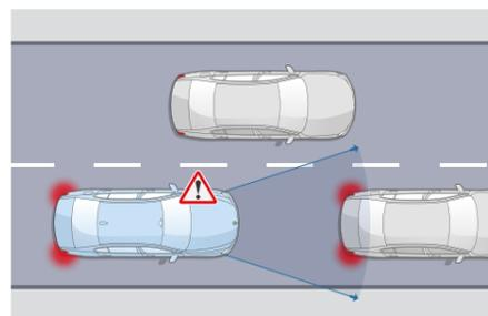
**Détection de collision avant avec freinage**
