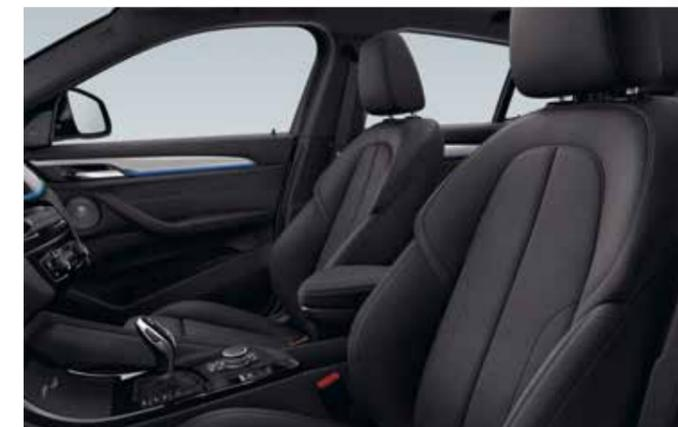
Avant même que le moteur n'ait atteint sa température de fonctionnement, les **sièges avant chauffants** diffusent une agréable chaleur sur simple pression d'un bouton, même par des températures extérieures glaciales. Les éléments chauffants réchauffent l'assise mais aussi le dossier des sièges. Les sièges chauffants contribuent ainsi à détendre les muscles du dos. L'option offre trois niveaux de puissance ainsi qu'une fonction "Chauffage rapide" pour la phase de démarrage.
