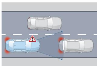
**Détection de collision avant avec freinage**
