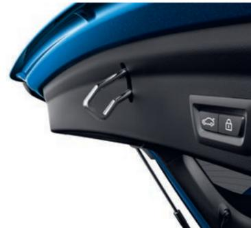
La **commande électrique du hayon** permet de l'ouvrir et de le fermer d'une simple pression sur un bouton.
