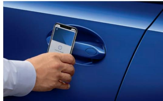
L'**Accès Confort** permet d'ouvrir les portes conducteur et passager et de démarrer sans avoir à sortir la clé de sa poche. La clé numérique Digital Key permet également d'accéder au véhicule et de le démarrer.
