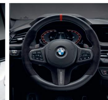
**Volant 3 branches en Alcantara** particulièrement agréable au toucher, il permet d'obtenir plus de maintien et de confort en conduite sportive.
