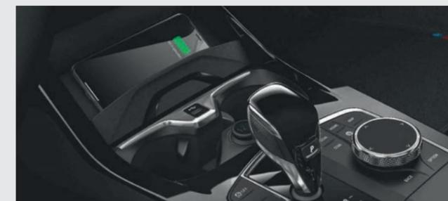
La plaque de **recharge sans fil par induction** permet de recharger le mobile sans câble et de le coupler par induction à l'antenne de toit. Peut être utilisée pour tous les appareils équipés de la technologie de recharge Qi.
