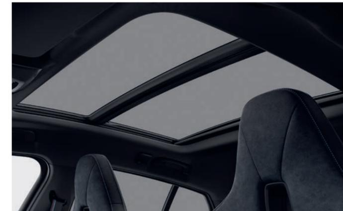
**Toit panoramique en verre électrique**, coulissant et entrebâillable à l'avant, avec pare-soleil, déflecteur et ouverture Confort via la clé radiocommandée.
