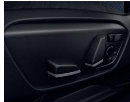
L'option **Sièges avant électriques** permet d'amener les sièges dans les positions souhaitées et de mémoriser celles du siège conducteur et des rétroviseurs extérieurs.
