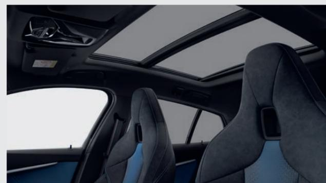
**Toit panoramique en verre électrique**, coulissant et entrebâillable à l'avant, avec pare-soleil, déflecteur et ouverture Confort via la clé radiocommandée.
