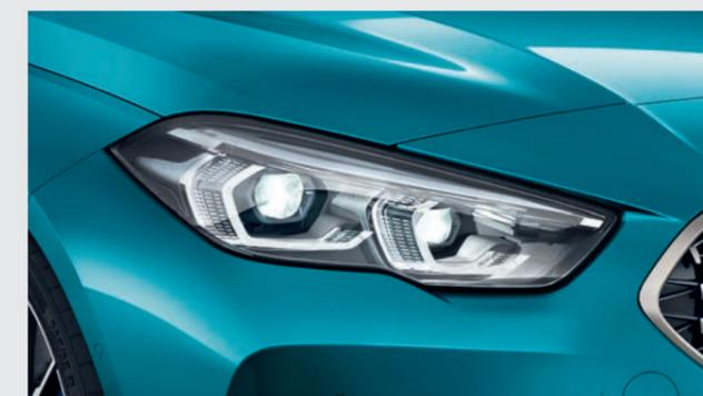
**Pack Advanced Full LED** : L'équipement comprend une gestion automatique des feux de route. La fonctionnalité anti-éblouissement "BMW Selective Beam" avec projecteurs directionnels répartis de façon variable le faisceau lumineux pour un éclairage optimal de la route dans l'obscurité.
