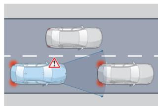
**Détection de collision avant avec freinage**
