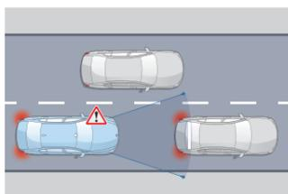
**Détection de collision avant avec freinage**
