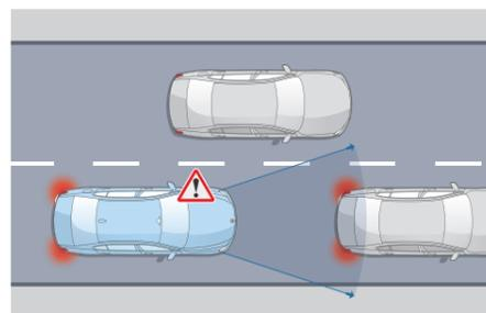
**Détection de collision avant avec freinage**
